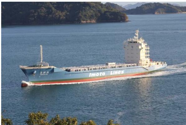
推進性能追求の為に、可変ピッチプロペラに及びプロペラボスキャップフィン(PBCF)を装着して常時、機関出力の効率化を可能としました。また航海支援用に高度船舶安全管理システム(HANASYS EXPERT)を搭載して、主機のデータをインターネット回線を介して 24 時間陸上から監視することによって異常の早期発見や故障の未然防止を図ると同時に、整備費用の削減や機関員配乗の削減にも結び付けます。
