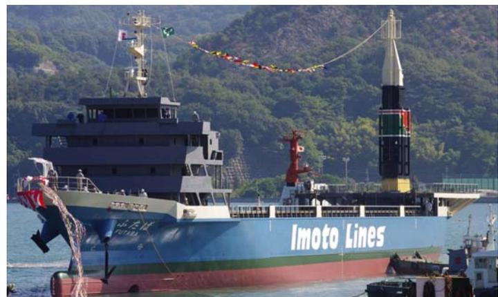
本船は、省エネ運航追求の為に、内航コンテナ専用船では日本初となる 2 基 2 軸電気推進システムを採用し、低負荷航行を可能としました。発電機 1 基での 2 軸運航も可能とし、出力レベルを必要に応じて調整する事で大幅な省エネ運航を実現。
