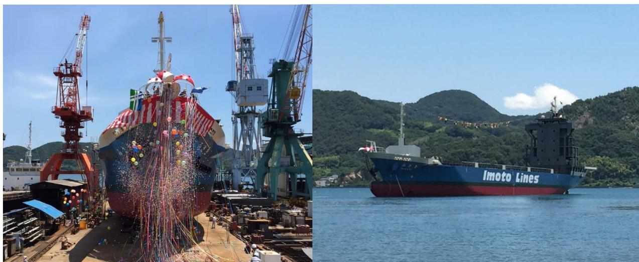
本船は、中速主機関駆動軸発電機 (PWM 装置付) を装備し、軸発単独使用は勿論、独立した発電機との並列運転を常時可能としました。また主機関は、発停時、入出港時において常時 C 重油の使用が可能。推進器には可変ピッチプロペラを装着し、電動駆動可変ピッチスラスタとフラップラダーの装着により離着岸性能の向上が図られています。
