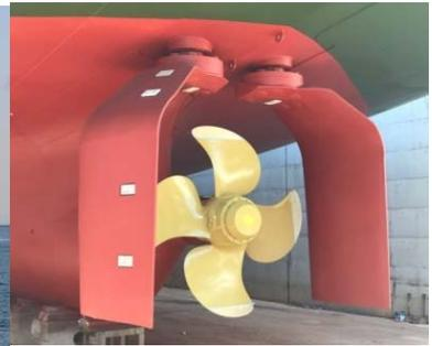
本船は、2013年に就航した400TEU積の「さがみ」型の同型船であり、2016年就航の「さくら」に続く3番船として計画されました。本船の最大の特長は、世界で初めてゲートラダーを装備したことです。従来の舵は、プロペラの後方に取付けられていた為、推進力の抵抗となっていたが、本船のゲート型ツインラダーは特殊形状の2枚の舵をプロペラの両側に配し、舵抵抗を低減し、推進力を無駄なく使うことができ燃費が向上します。また、低速時にはプロペラの水流を変えてスラスタの働きをすることにより、高出力のバウスラスタとの併用により、離着岸時性能を飛躍的に向上させました。その上、プロペラの後ろの障害物がなくなったことで、船体振動・騒音を低減させました。（本事業は、公益財団法人日本財団の助成を得ています。）
