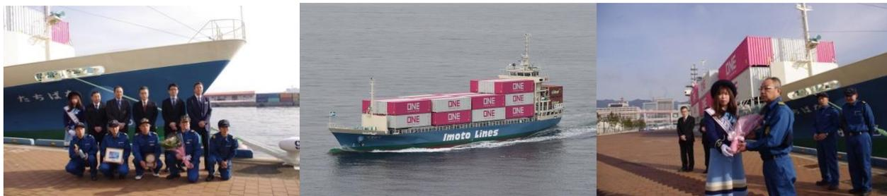
当社は、2004 年からコスト削減を目指して大型化を推進していましたが、貨物や航路の特性に柔軟に対応して、2017 年度 3 隻目の 499G/T 型船として「たちばな」を竣工させました。本船は、先に竣工した 2 隻を上回る 137TEU 積とし、冷凍コンテナを最大 40 本積載可能としました。また、火薬類、低引火性液体などの危険品コンテナを艙内及びデッキ上に 20 フィートコンテナで 30 本搭載可能とするなど、最新の技術及び設備を備えております。
